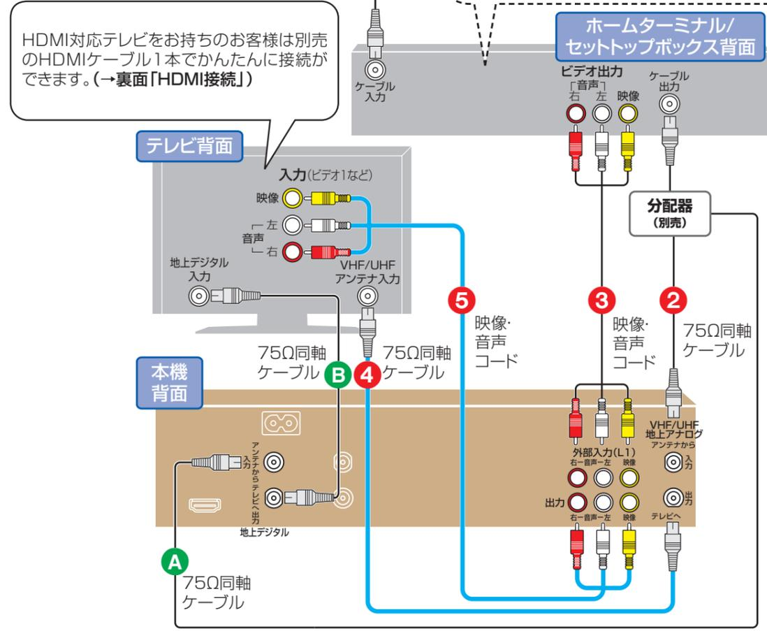
CATVホームターミナル/セットトップボックスの接続 **1** **2** **3** のあと、テレビとの接続 **4** **5** を行ってください。地上デジタル放送の伝送がパススルー方式の場合、分配器を使って **A** **B** を接続してください。CATV会社によって伝送方式は異なります。
