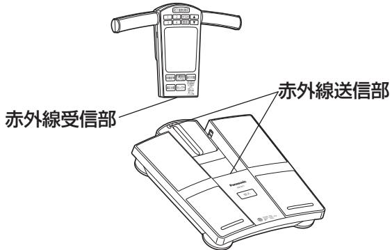
本機は赤外線で本体と操作部の間で通信を行います。本体の赤外線送信部から操作部の赤外線受信部で受信するようになっており、操作部の位置や周囲の環境(照明や太陽光等)によっては、通信できない場合があります。
