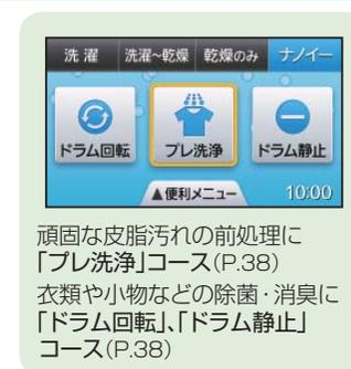
頑固な皮脂汚れの前処理に「プレ洗浄」コース (P.38)
