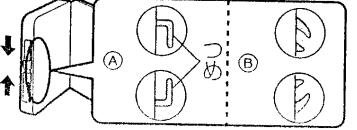
つめが図Aのように開いていたら、[OPEN] を押して図Bのようにする。
