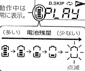
極端に低温の場所での使用や早送り・巻戻し中は、一時的に低く表示されたり、点灯していても正しく動作しないことがあります。
