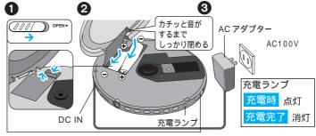
電池残量を使いきらなくても継ぎ足し充電が可能です 長期間使用しないときは、ACアダプターを、コンセントから抜いておくことをおすすめ します。電源「切」状態でも約0.1 Wの電力を消費しています。
