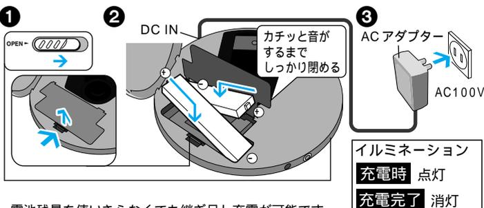
電池残量を使いきらなくても継ぎ足し充電が可能です。長期間使用しないときは、AC アダプターを、コンセントから抜いておくことをおすすめします。本体を接続していない状態でも電力を消費しています。(約 0.1 W 以下) 電池を取り出すときは○側を押すと、電池が持ち上がります。電池ふたがはずれたら、ふたが浮かないようにしっかりとめ込んでください。ディスクに、傷がつくおそれがあります。
